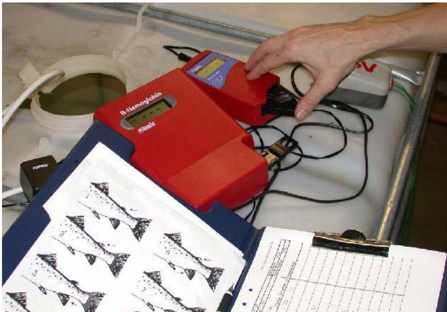
Figur 2 visar protokoll och mätare för Hb och glukos på en av provbehållarna.
